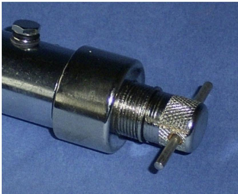
Das Hauptventil ist aufgedreht und entspannt. In dieser Position fließt kein Gas. In dieser Stellung muß auch die Kapsel angeschlossen werden.
