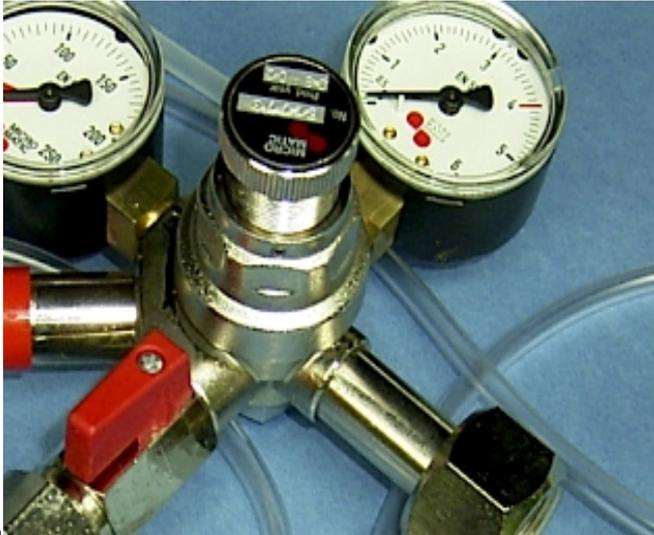
Die Feineinstellung wird mit Hilfe der zentralen gerändelten Feinstellschraube des Ventilkörpers vorgenommen.
