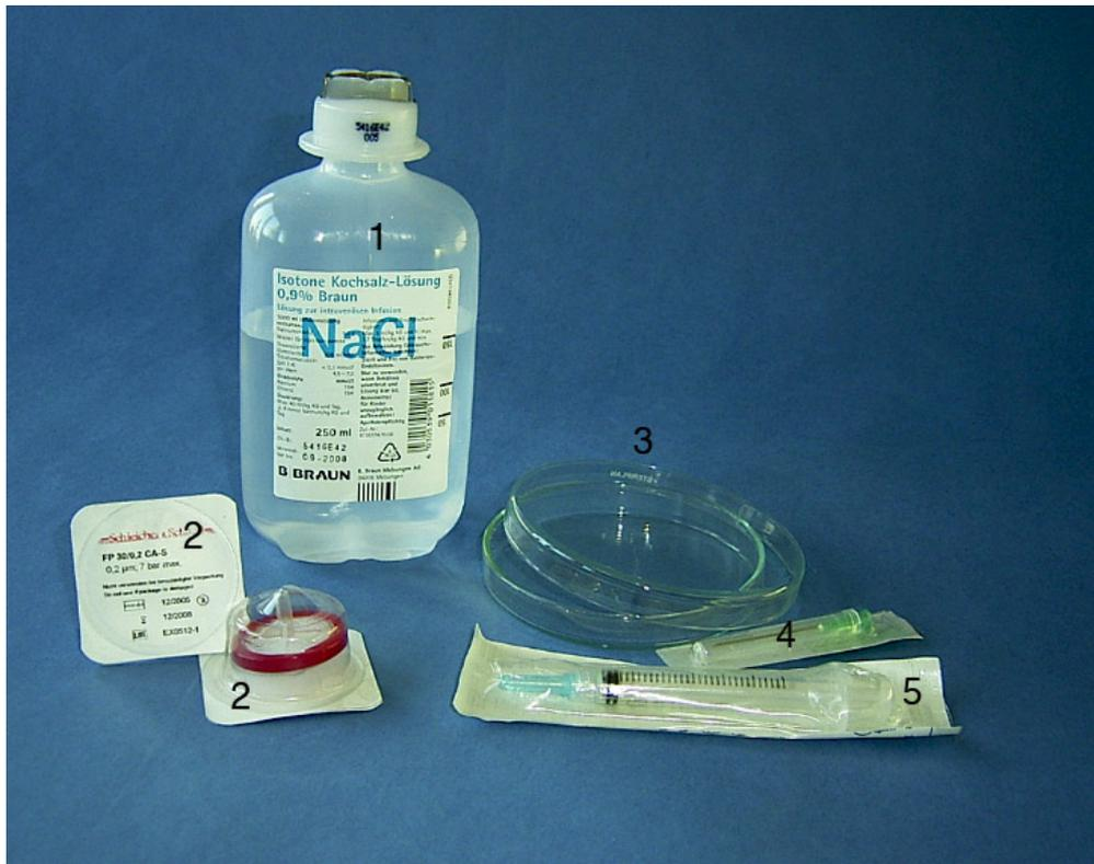
Unverzichtbar sind die NaCl-Lösung 0,9 % (1), Einwegspritzen mit Kanülen (4, 5). Nicht fehlen sollte das Petrischälchen mit Decker (3). Der vor die Einwegspritze geschaltete Bakterienfilter (2) stellt sicher, daß keine schädlichen Keime in die Spitze gelangen können (wenn z.B. die Lösung nicht mehr ganz frisch ist) – Fabrikat SCHLEICHER + SCHUELL, FP 30/0,2 CA-S 0,2 µm.
