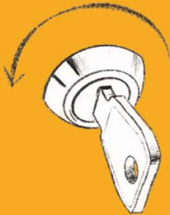
4. Bei vollkommen entlasteten Wiegezellen (0 kg) den Schlüsselschalter auf 12 Uhr zurückdrehen.
