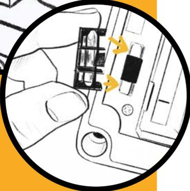
7. Öffnen Sie das Gehäuse der Elektronik (Schlitz-Schraubendreher wird benötigt) und legen Sie die Sicherung ein.
