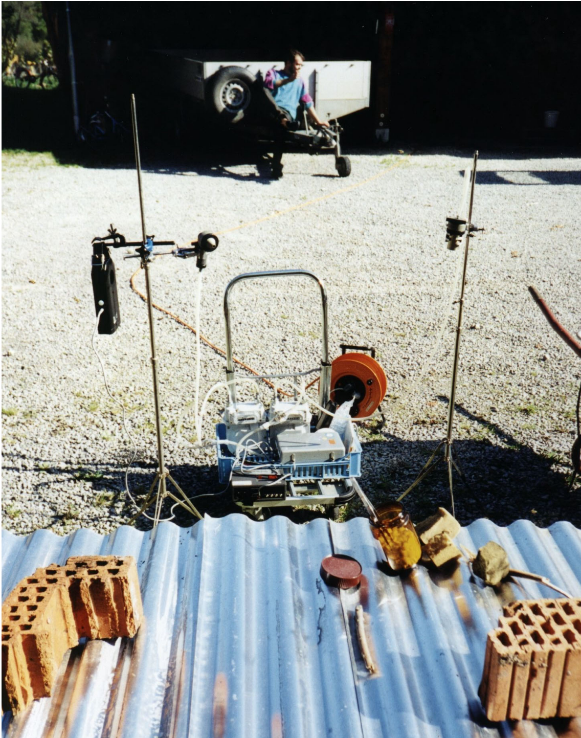
Abb. 6: Die vor dem Bienenkasten aufgebaute Meßapparatur bei der Probenahme während des Verdampfungsprozesses. Inzwischen wartet der Imker in gebührendem Abstand im Hintergrund.
