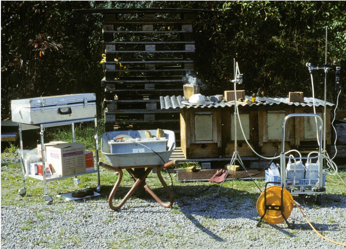
Abb. 1: Überblick über den Aufbau der Meßgeräte. Rechts die auf Ständer montierten Probensammelköpfe für die einatembare und die alveolengängige Partikelfraktion. Dahinter die Bienenkästen. Davor die Luftsammelpumpe und die Volumenmeßgeräte auf einem Wägelchen. In der linken Bildmitte eine Autobatterie zum Betrieb des „Varrox®-Verdampfers“ auf einer Schubkarre. Ganz links ein Koffer mit Zubehör.
