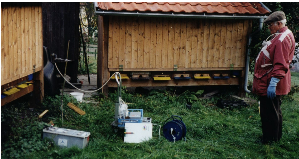
Abb. 4: Der Imker wartet etwas abseits, bis die Oxalsäure im Bienenstock verdunstet ist. Die portable Luftsammelpumpe trägt er in seiner Jackentasche mit sich.
